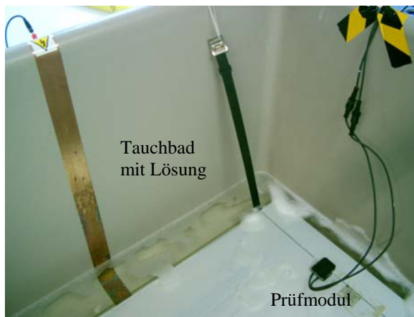
Abbildung 5 – Kriechstromprüfung unter Benässung
