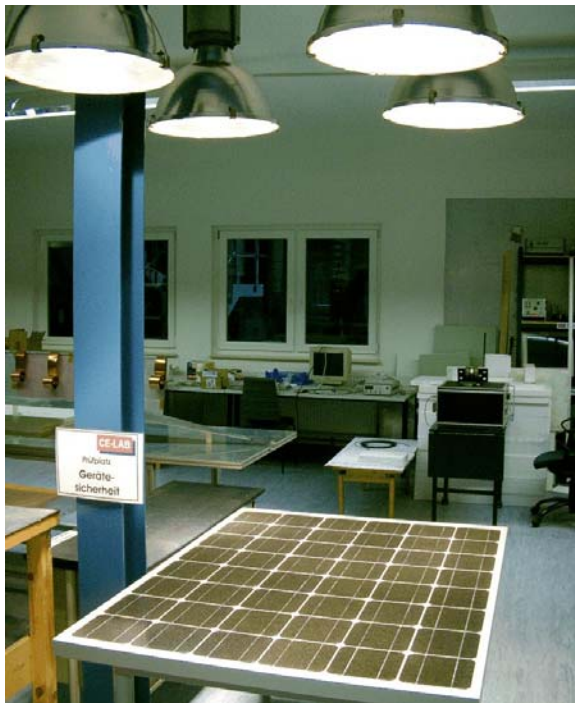
Abbildung 2 – Visuelle Kontrolle / Beleuchtungstest
