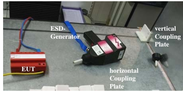
Abbildung 7 – Messplatz zur ESD-Prüfung
